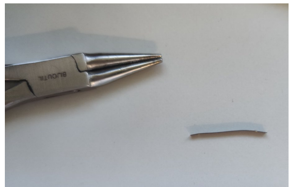
Figure 180 ci-dessus : Ressort avant intervention. Ci-dessous : Ressort reformé à l'aide d'une pince.
