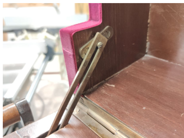
Figure 101 : Système de maintien du couvercle complet.
