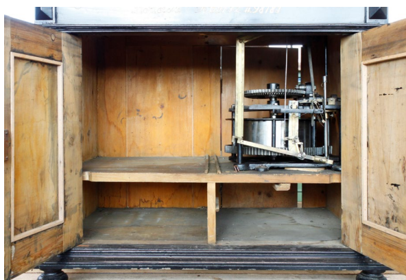
Figure 106 : Intérieur « incomplet ». Tiroir de récupération de la monnaie et cloison de séparation de l'étage supérieur manquants.
