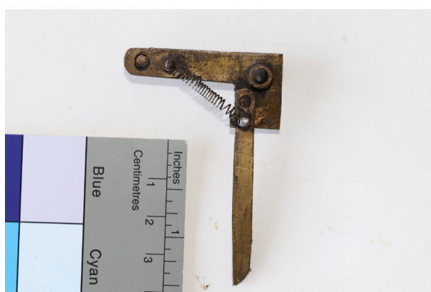
Figure 56 : Corrosion des éléments en alliage cuivreux.
