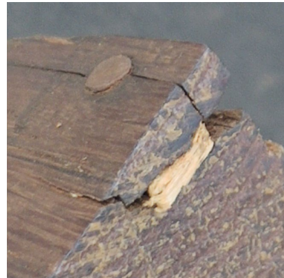
Figure 105 : La pièce a été stabilisée par l'ajout d'un clou et un fragment de bois a été utilisé pour combler la lacune.
