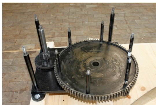
Figure 146 : Les colonnes sont remplacées à leur emplacement original après démontage complet du mécanisme et retrait du ressort.
