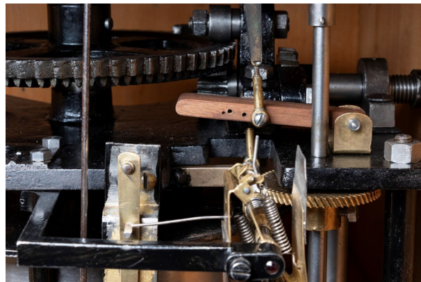
Figure 23 : Détail du mécanisme moteur : alliages ferreux, cuivreux et bois. État après traitement.
