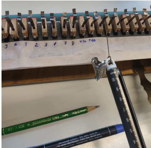
Figure 179 : La force de chaque ressort de rappel a été mesurée puis ajustée.
