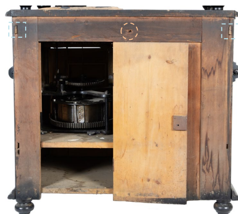
Figure 28 : Vue de l'arrière. En bleu : Les cales. La perforation au centre aurait permis de fixer une cloison (orange). État avant traitement.
