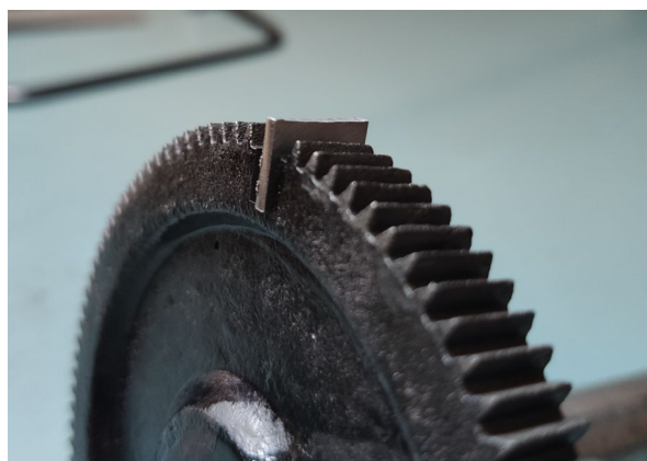
Figure 176 : Mise en place des plaquettes et collage.
