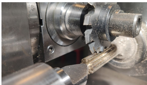
Figure 180 : Pignons en cours d'usinage.
