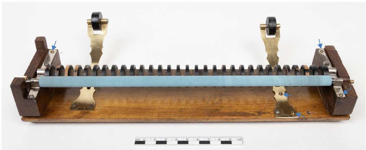
Figure 190 : Les vis changées ou ajoutées sont indiquées par des flèches bleues.
