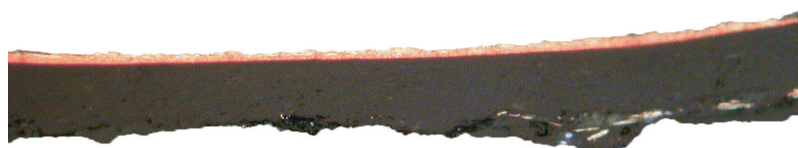
Figure 21 : Échantillon de la dorure sur l'avant du cabinet. Agrandissement 10x.
