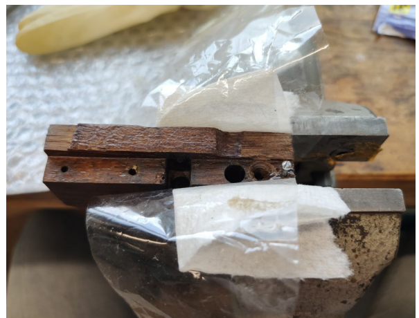
Figure 185 : La vis a été remplacée en maintenant la pièce dans un étau.
