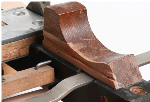
Figure 186 : La bordure inférieure du pont en bois est fortement abrasée.
