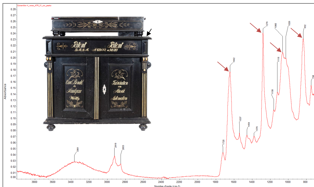
Figure 7 : Spectres FTIR de la peinture du plateau du cabinet. Les pics à 1642, 1276, 1060 et 832 sont caractéristiques des nitrates de cellulose.
