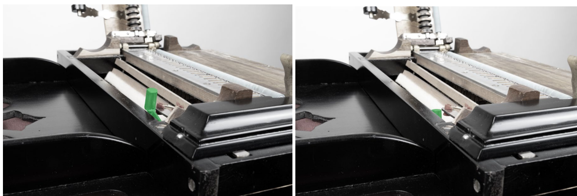
Figure 52 : Photographie optimisées montrant le levier d'arrêt en position « neutre » (à gauche) et en position « basse » (à droite) comme si une partition appuyait dessus. État après traitement.
