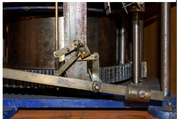
Figure 127 : Vu détaillé du monnayeur (Bruchsal).
