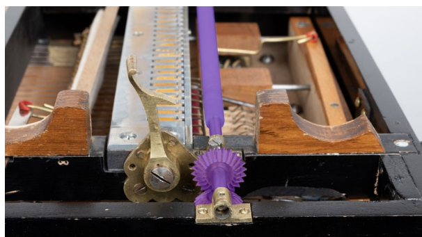
Figure 56 : Photographie optimisée montrant les pignons coniques (F) et (F1) et la tige en caoutchouc (H) - schéma ci-contre pour la correspondance. État après traitement.
