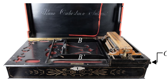
Figure 17 : Boîtier complet : avec couvercle et plateau ajouré, son cylindre amovible (A) et les guides (B-B'). Les leviers de changement de la dynamique sont visibles à l'extérieur du boîtier (C). État avant traitement.
