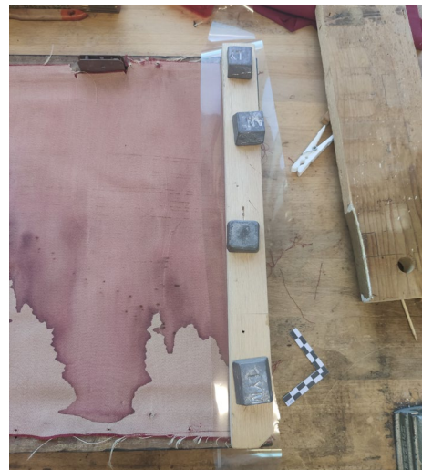
Figure 178 : Mise sous presse d'un textile lors du séchage de l'adhésif.
