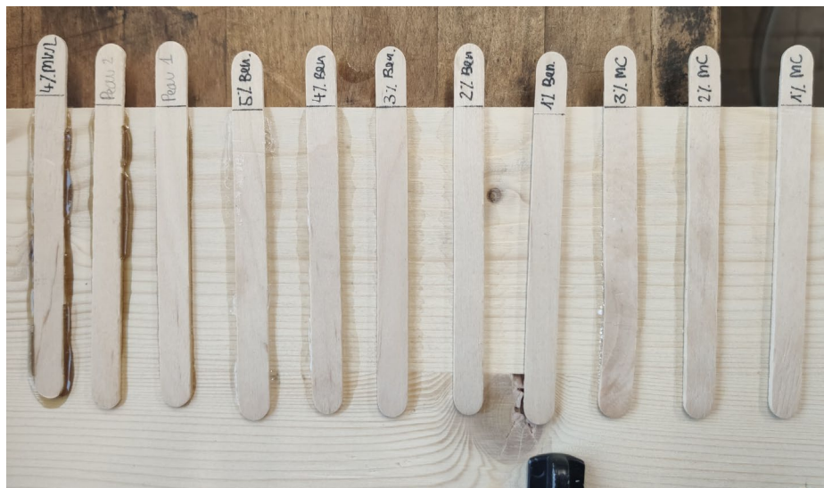
Figure 136 : Test d'adhérence de différents adhésifs à des concentrations différentes. Après un temps de séchage, la force nécessaire à l'arrachement des baguettes a été mesurée avec un dynamomètre.
