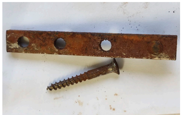
Figure 80 : Différent degré de corrosion des vis des poignées. Ceux de la poignée de la paroi de droite sont plus corrodés que ceux de celle de gauche (ici la poignée de gauche correspond au côté droit de l'objet).
