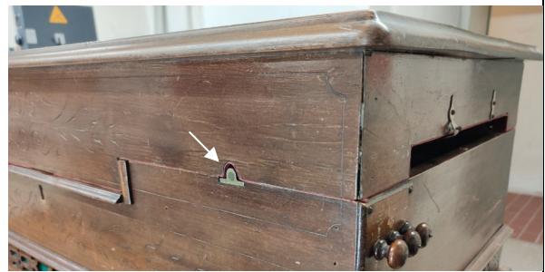
Figure 93 : L'extrémité de la tige filetée a été sciée (Bruchsal).
