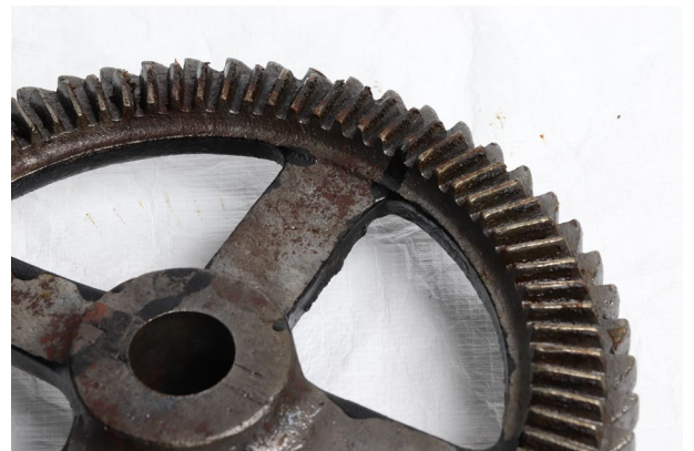
Figure 51 : Encrassement et corrosion du rochet.
