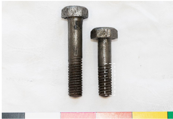
Figure 119 : La face de la vis de droite du pont de la vis d'armement est très abrasée.
