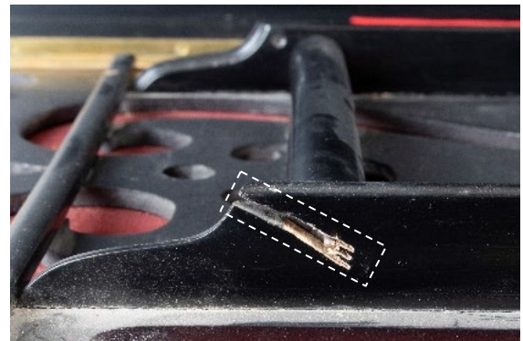
Figure 82 : Découpe à la scie et perçage des guides.
