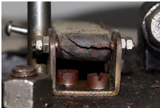
Figure 121 : Vue in situ : Fentes dans l'axe de rotation du levier oscillant.
