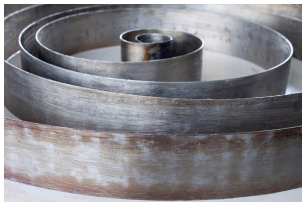
Figure 167 : Ressort après nettoyage et lubrification.
