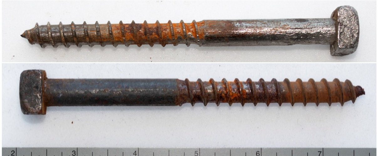
Figure 114 : La vis supérieure présente une surface métallique brillante, tandis que l'autre présente un état de surface propre à un état après forgeage industriel.
