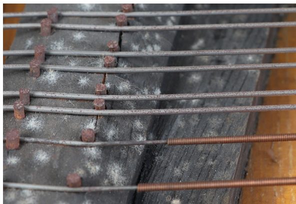
Figure 90 : Corrosion éparse et ponctuelle sur les cordes en acier ; Corrosion plus importante des goupilles ; Ternissement des cordes filées ; Fissuration du pont en bois.
