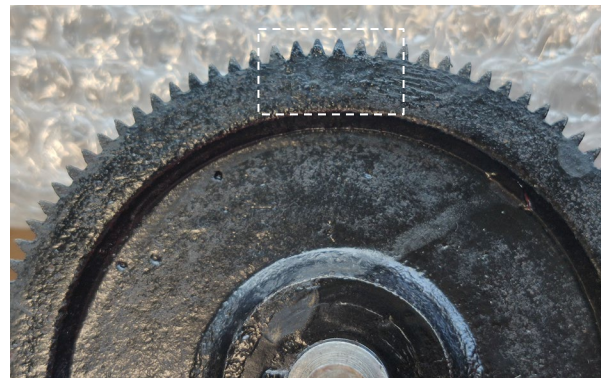
Figure 179 : Application d'une deuxième couche de Regalrez® sans pigments.
