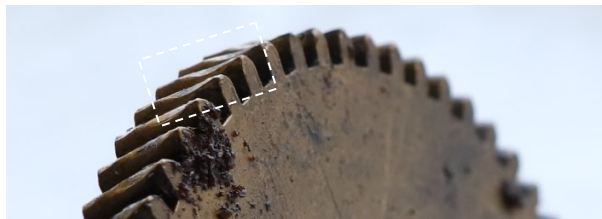
Figure 115 : Abrasion légère des dents.
