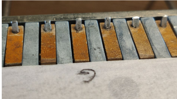
Figure 172 ci-contre : La hauteur des goupilles a été ajustée puis les bouts limés.
