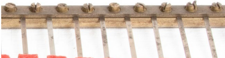
Figure 98 : Les têtes des vis en alliage cuivreux de l'arbre à marteaux présentent des déformations mécaniques plus ou moins importantes.
