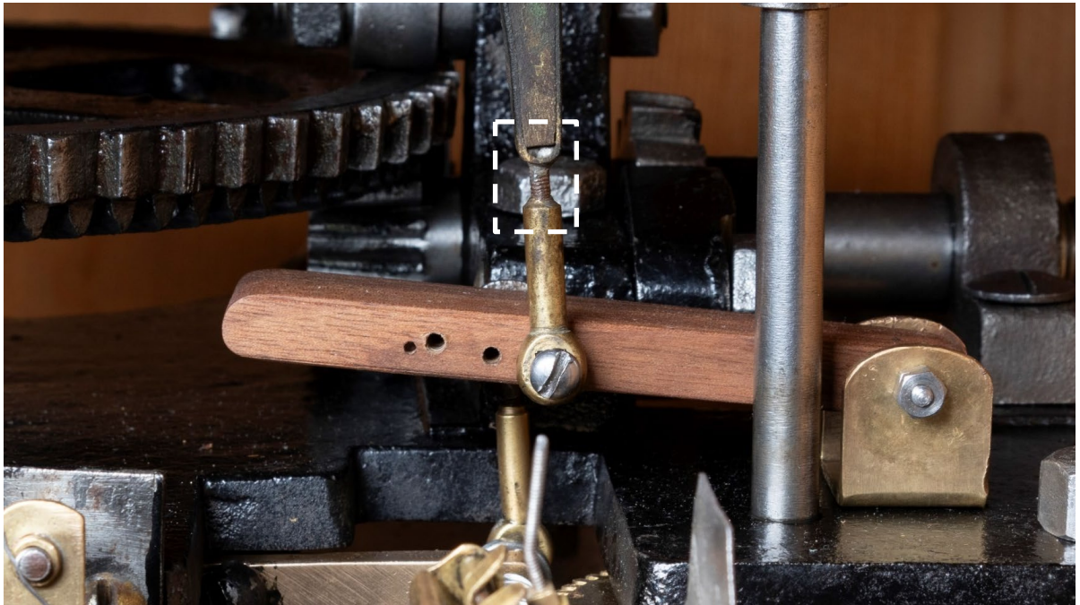
Figure 169 : La hauteur des marteaux peut être réglée grâce au filetage présent sur l'extrémité de la tige.
