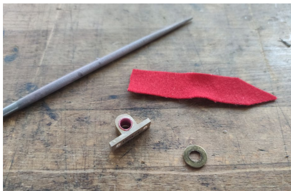
Figure 160 : Matériel et outil pour l'ajustement des feutres des ponts en laiton.
