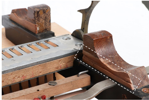
Figure 95 : Irrégularités dans les bordures des guides de la barre de suivi.
