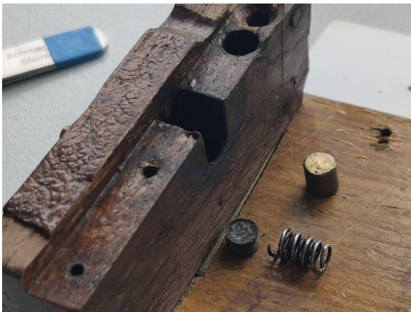
Figure 106 : Un ressort et un intercalaire en laiton ont été ajoutés dans la fixation du cylindre en bois de la barre de suivi.
