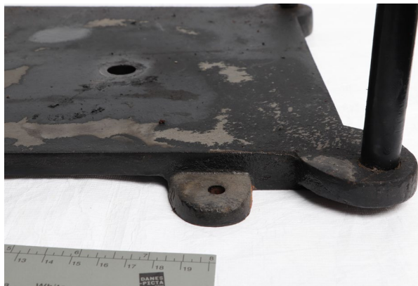
Figure 50 : Encrassement de la platine inférieure.
