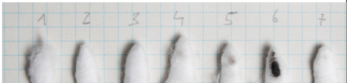
Figure 135 : Test de solubilité de la peinture du cabinet : Bordure inférieure gauche. Les solvants utilisés sont : 1) White Spirit 2) Shellsol T 3) Isooctane 4) Isopropanol 5) Éthanol 6) Acétone 7) Eau déminéralisée.
