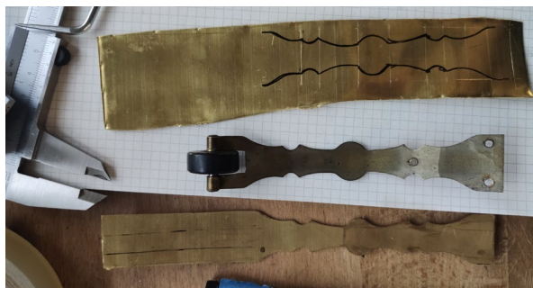
Figure 172 : Tige à roulette en cours de découpe.
