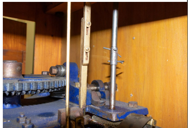
Figure 125 : Système de modulation de l'intensité sonore différent de celui breveté par Carl Bendel.
