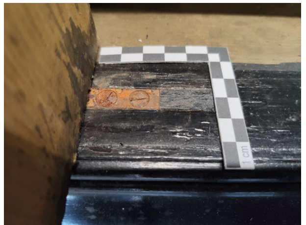
Figure 79 : Corrosion des charnières des portes.
