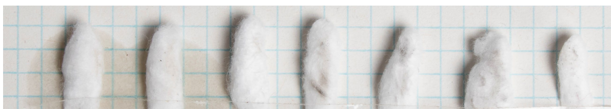
Figure 132 : Test de solubilité de la peinture du mécanisme moteur, sur une surface ne présentant pas d'encrassement. Les solvants utilisés sont les suivants (de g. à d.) : White Spirite, Shellsol T, Isooctane, Isopropanol, Ethanol, Acétone et Eau déminéralisée. La surface ne réagit pas ou peu aux solvants testés dans ces conditions.
