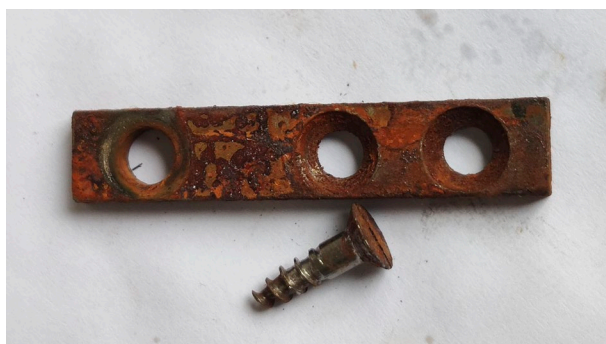
Figure 81 : Ci-dessus et ci-contre : Corrosion des charnières des portes.
