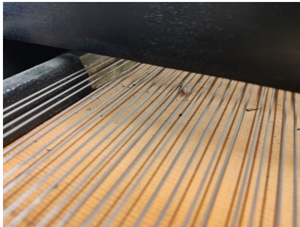
Figure 42 : Empoussièrement de l'instrument.
