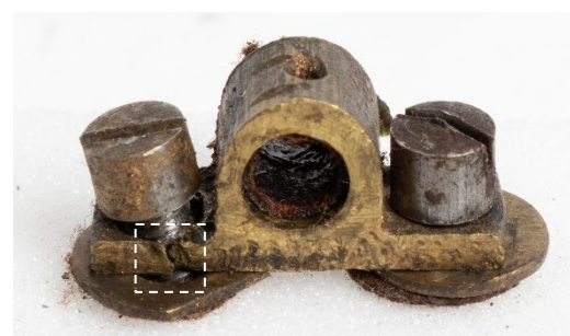
Figure 103 : Les ponts en alliages cuivreux de l'arbre à marteaux sont ternis, sales et celui de droite est fissuré. L'insert en feutre est très dégradé.
