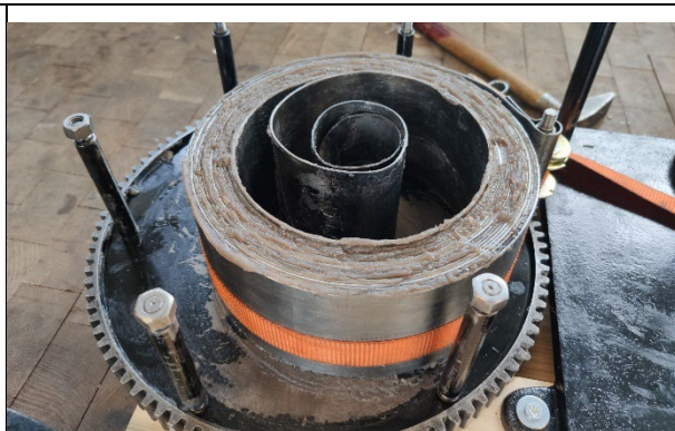
Figure 147 : Le ressort, maintenu par la sangle, peut être sorti et remplacé dans le barillet. Ici après traitement et lubrification.
