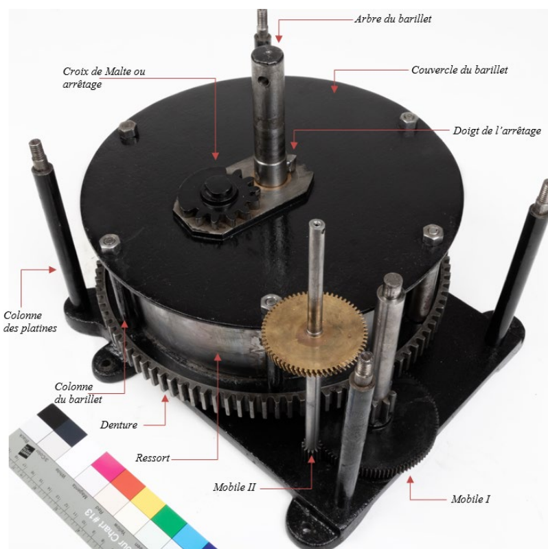
Figure 25 : Mécanisme moteur à ressort partiellement démonté. État après traitement.
