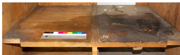
Figure 131 : Intérieur du cabinet après démontage et retrait du mécanisme moteur : encrassement important, tache de peinture et d'huile/graisse.
