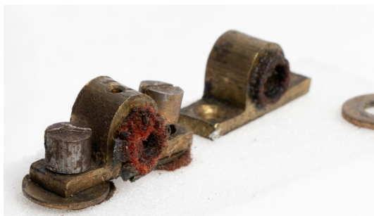
Figure 103 : Les ponts en alliages cuivreux de l'arbre à marteaux sont ternis, sales et celui de droite est fissuré. L'insert en feutre est très dégradé.
