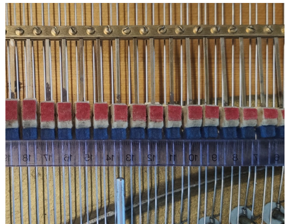
Figure 171 : Ajustement de la longueur des marteaux, qui doivent être tous de la même longueur. Ici une règle a été utilisée pour contrôler l'alignement des marteaux.
