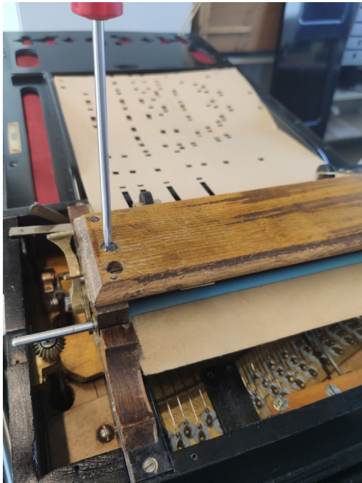
Figure 176 ci-contre : Le réglage de la force de pression du cylindre en bois et des cylindres de transport s'est fait grâce aux vis dans le couvercle de la barre de suivi.
