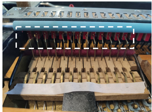
Figure 181 : Réglage des ressorts de l'arbre à marteau « Fortissimo ».
